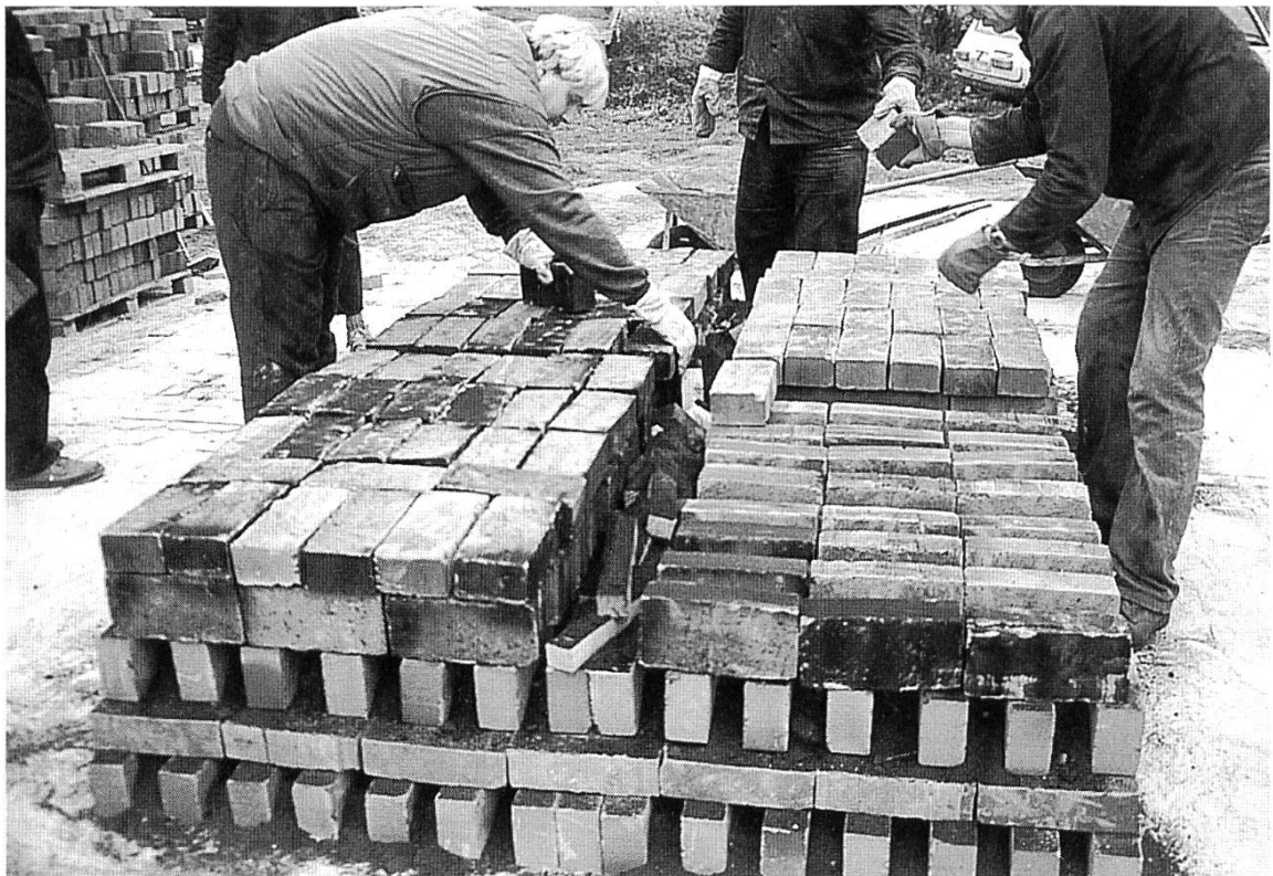
Abb. 1 ► und 2 ►► Beim Feldbrandmeiler bildet das Brenngut selbst den Ofen. Im Bild 1 wird in der Ziegelei Hundisburg der Herd eines Demonstrationsofens, im Bild 2 der darauf folgende Gitterbesatz gesetzt.
