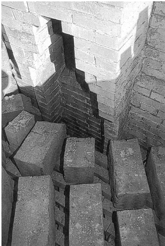
Abb. 8 Gitterbesatz im Ofen, nach dem Brand. Nur die Backsteine nahe beim Kamin bildeten Risse und etwas Schmolz.
