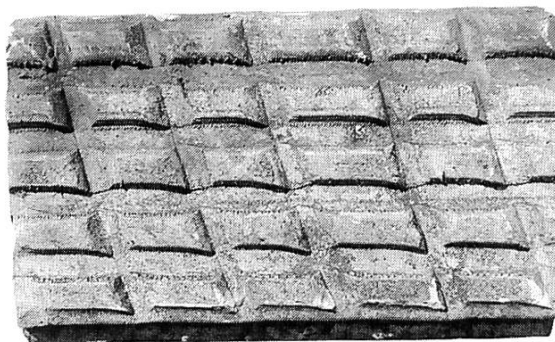
«Planelle» d'écurie fabriquée à Vinzel, percée de trois trous, à emboîtement latéral et surface à rigoles longitudinales entrecroisées de rainures obliques; modèle prévu pour être posé à l'envers dans les porcheries (dimensions 32,5x20x7 cm).
