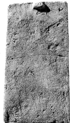
Fig. 10 Tuile gironnée à découpe droite, fabriquée «à la française» et découverte lors des fouilles effectuées au château d'Yverdon en 1979. Elle est du même type que celles observées sur le toit de la tour des juifs (2 e moitié XIII e –1 ère moitié XVI e siècle).
