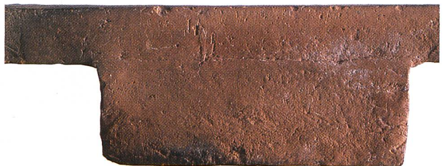
Abb. 15 Hirsau, St. Aurelius. Detail der Nase mit geglättetem Grat an der Naht zwischen Ziegelplatte und der Leistennase.
