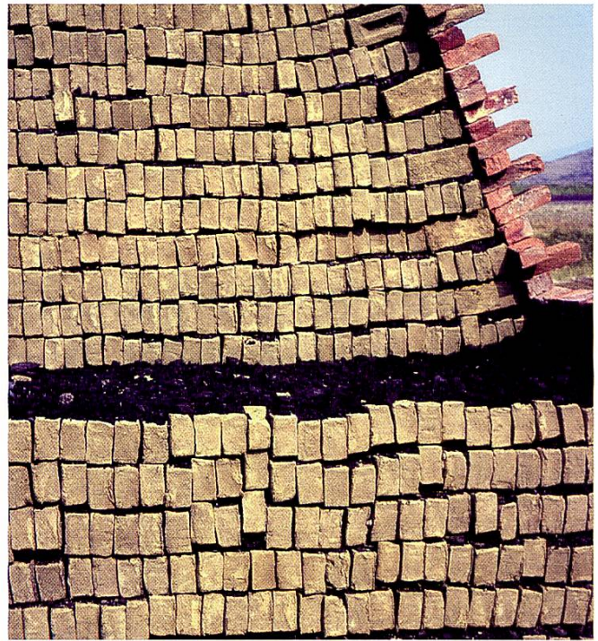
Feldbrandziegelei in der Türkei: Abtragen der gebrannten Backsteine (links) und Querschnitt durch einen frischen Meiler mit Kohleschichten (rechts). Zusendung von Prof. Dr. Klaus Nohlen, Strassburg F (k.nohlen@wanadoo.fr)
