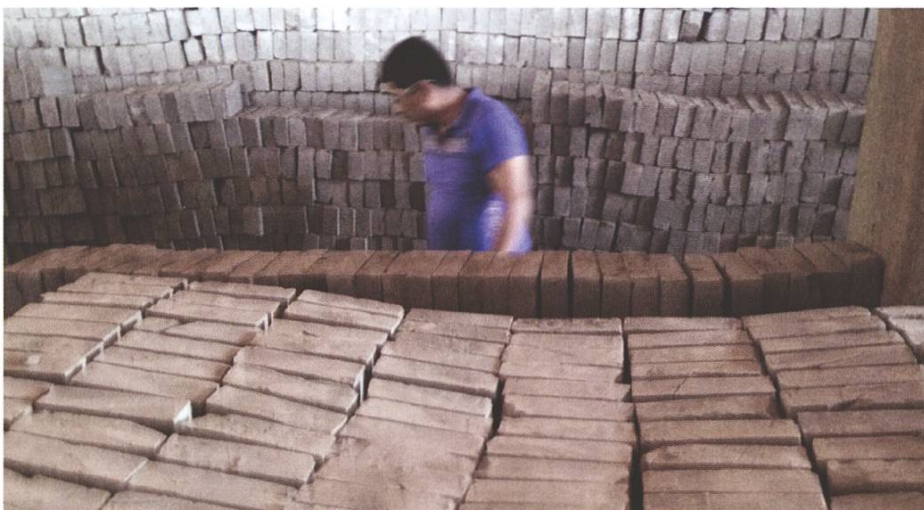
Abb. 5 Hinten getrocknete, vorne in den Ofen gesetzte Steine. Der Fachmann erkennt sogleich, woran es hier mangelt. – Die höhere Brenntemperatur in der Ofenmitte verursacht ungleiche Schwindung, die sich bis oben als Durchhang auswirkt.
