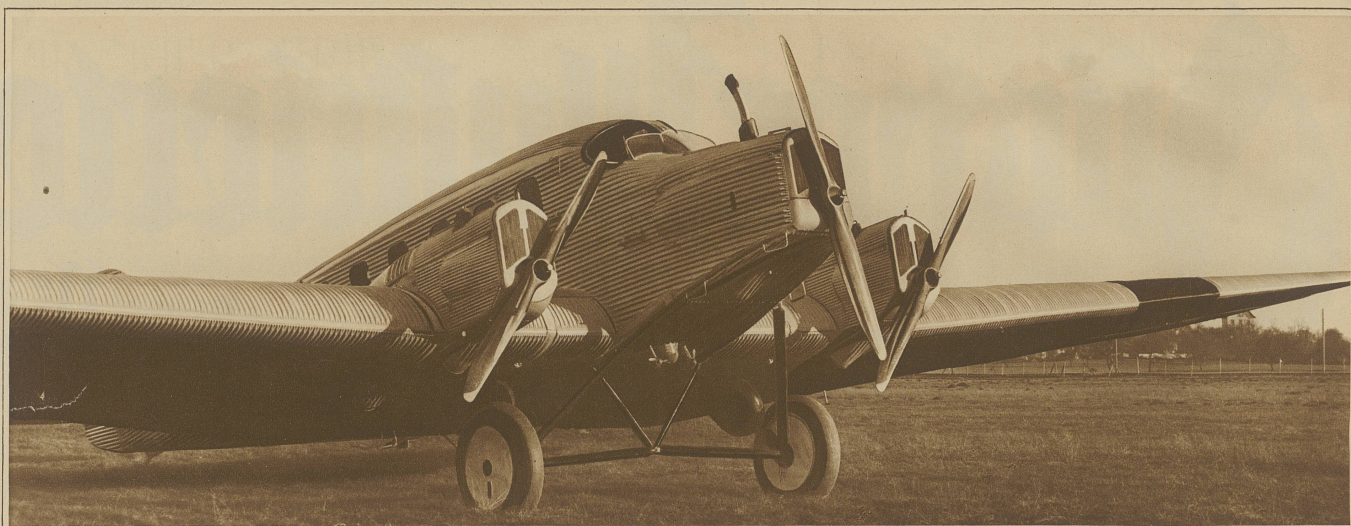
Das neue mit drei Motoren von je 250 P. S. ausgerüstete Junker-Ganzmetallgrosßflugzeug vor dem Start zum Alpenflug
