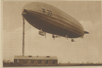
Das englische Luftschiff R 33 am Ankerplatz in Pulkovo. Zwischen den beiden Gondeln ist das aufblasbare Flugzeug ersichtlich.
