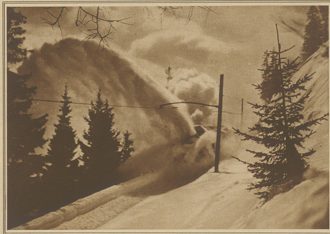
Schneeschleudermaschine der Berninabahn in voller Tätigkeit
