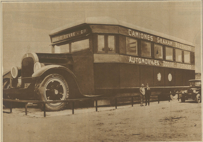
Der größte Omnibus der Welt wurde ausnahmsweise einmal nicht in den U.S.A., sondern in Buenos Aires anlässlich der dortigen internationalen Automobil-Ausstellung gebaut. Er hat folgende, phantastisch anmutende Ausmaße: Raddurchmesser 2,75 m, Kühlerhöhe 2,60 m, Karosseriehöhe 8,20 m, Karosserietiefe 7 m, Karosserielänge 65,8 m, Gesamthöhe 12 m, Gesamtlänge 99 m. In diesem Bus haben 54 verpackte 4-5-plätige Automobile und 8 Chassis Platz
