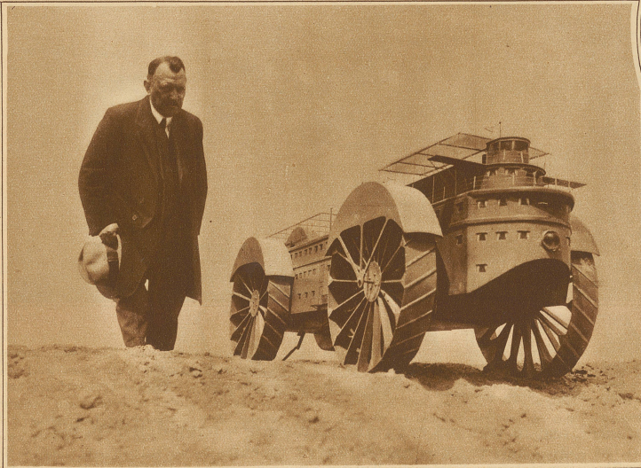
Modell eines Wüstenschiffes für Transport- und Forschungszwecke in Wüsten und Steppen. Das Fahrzeug wird durch zwei Dieselmotoren angetrieben und ist mit dem modernsten Komfort ausgestattet. Neben dem Modell der Erfinder Ingenieur Bischoff
