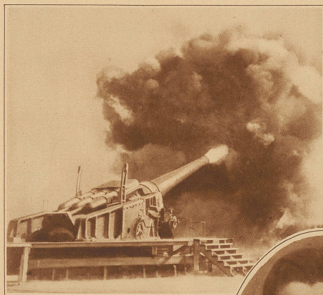
Abschuß eines neu gebauten 16 Zoll Langrohr-Geschützes auf dem Prüffeld von Aberdeen bei Washington. Es ist dies das größte Geschütz, das bis heute gebaut wurde
