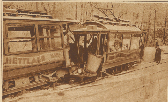
Schweres Straßenbahnunglück in Kassel. Durch Versagen der Bremse raste ein Wagen der Kasseler Straßenbahn bergab, sprang aus den Schienen und rannte in einen ihm entgegenkommenden Tramwagen hinein. Aus den Trümmern wurden 20 Verletzte hervorgezogen
