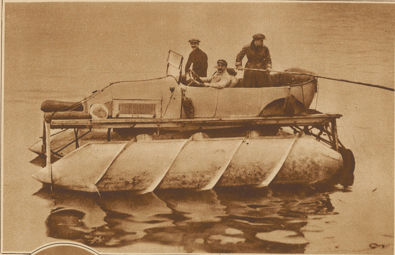
Ein neuer Typ eines Motorbootes, das seine ersten Versuchsfahrten auf der Seine machte. Die Vorwärtsbewegung erfolgt durch die Rotation der Schwimmer
