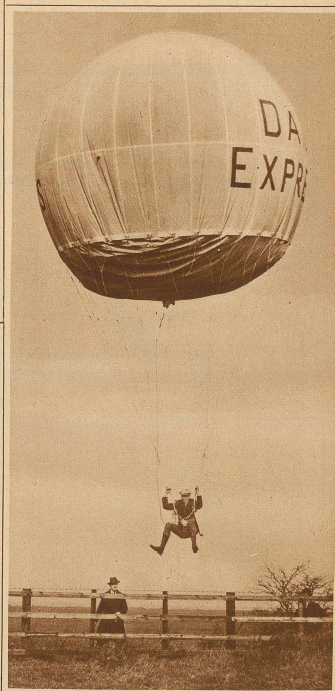
Das Ballonspringen, ein neuer Sport. Die Hülle wird nur so weit mit Gas gefüllt, daß der Ballon den Menschen nicht ganz zu tragen vermag, daß aber die Sprungkraft der Beine doch genügt, um Sprünge von über 100 m zu erreichen
