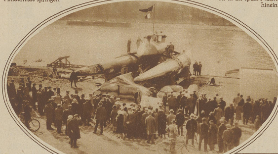
Der Ozeano-Glisseur ist das neueste Vehikel, mit welchem die Überquerung des Ozeans im nächsten Monat versucht werden soll. Wie das Bild zeigt, handelt es sich um ein Climbcoq, das außer mit Schrauben auch mit Luftpropellern angetrieben wird. Man rechnet mit einer durchschnittlichen Geschwindigkeit von gegen 100 km
