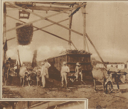
Das Umladen des Zuckerrohrs von den Ochsenspannen auf Bahnwagen. Jede Zucker-Raffinerie hat Felder von riesigen Ausdehnungen, die von einem ganzen Schienensystem durchzogen sind
