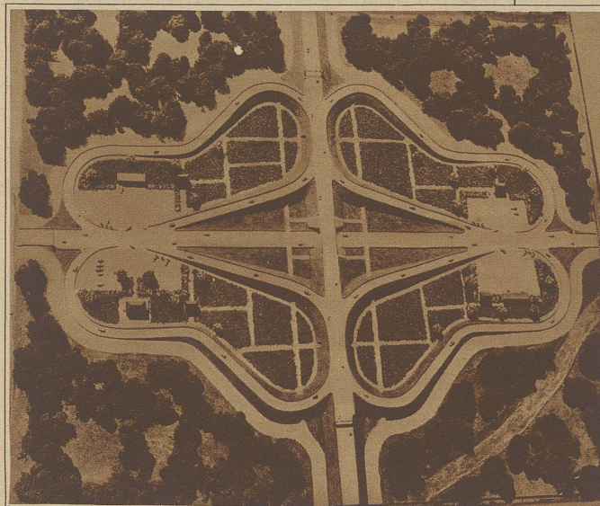
Ein neuer Vorschlag für die Anlage von Kreuzungen zweier Autostraßen. Dieses Modell zeigt eine einwandfreie Lösung des Problems, daß kein Auto die Fahrbahn eines andern kreuzt. Kommt beispielsweise im Bilde ein Fahrer von oben und will (von ihm aus gesehen) nach links abbiegen, so hat er bis zur letzten Abzweigung und dann nach rechts zu fahren. So kommt er, immer die rechte Straßenseite haltend, in der gewünschten Fahrrichtung auf die kreuzende Straße
