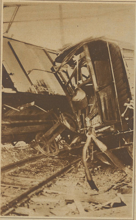
Zugsentgleisung im Bahnhof Wollishofen. Am Donnerstag früh entgleiste auf der Station Wollishofen bei der Einfahrtsweiche ein Güterzug aus der Richtung Zürich. Außer der Lokomotive wurden 15 Wagen aus dem Geleise geworfen, wovon vier völlig ineinandergeschoben und zertrümmert wurden. Personen wurden keine verletzt, denn auch der Zugführer, der sich im Moment der Entgleisung auf dem Bremsis eines völlig zertrümmerten Wagens befand, kam wie durch ein Wunder ohne die geringste Verletzung davon. Degegen ist der Materialschaden bedeutend
