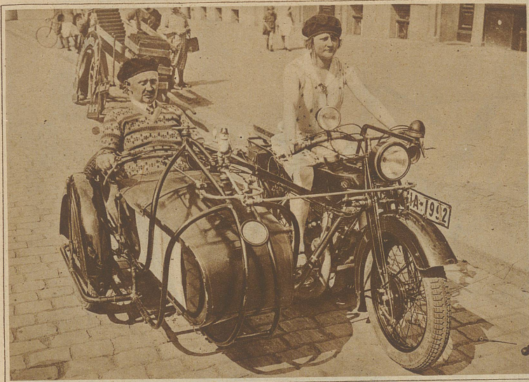
Ein neuartiges Motorrad ist von einem Berliner Fachlehrer konstruiert worden. Es kann vom Seitenwagen aus gesteuert und gefahren werden. Alle Handgriffe des Fahrers auf dem Motorrad werden automatisch auf die Beiwagen-Steuerung übertragen und der Fahrlehrer hat so seinen Schüler immer in seiner Gewalt
