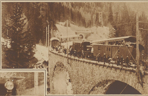
Die Unfallstelle auf dem Viadukt. Ein Personenwagen wurde vollständig in einen Gepäckwagen hineingeschoben. Durch sofortiges Bremsen der beiden Züge konnte der Zusammenstoß glücklicherweise so stark gemildert werden, daß die Wagen nicht in die Tiefe stürzten
