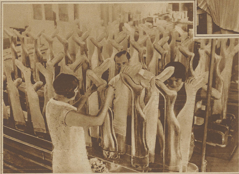
Blicke in die «Formerei» einer Strumpffabrik. Die Strümpfe werden teils über flache, teils über plastische Beinformen gezogen
