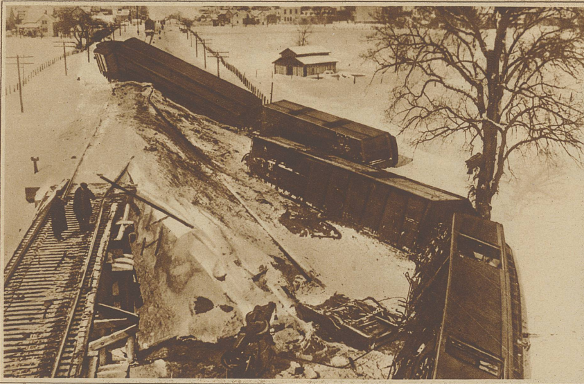
In alle Winde verstreut wurden die Wagen eines amerikanischen Expreszuges, der bei Kewaskum (Wisconsin) entgleiste. Da die stählernen Wagen dem Druck standhielten, gab es trotz des gefährlichen Aussehens nur wenige Verletzte
