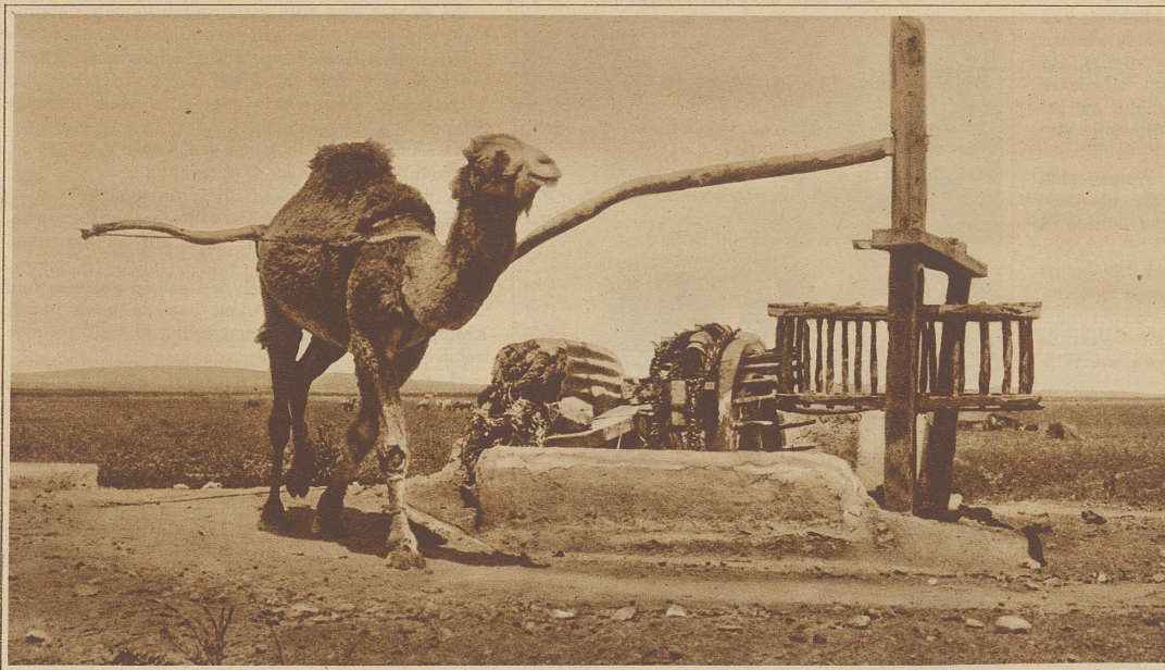
In den marokkanischen Wüstengebieten bedienen sich die Eingeborenen des Schöpfrades zur Bewässerung der spärlichen Weiden. An Stelle der Zahnräder werden Speichenkränze aus Holz als Getriebe verwendet
