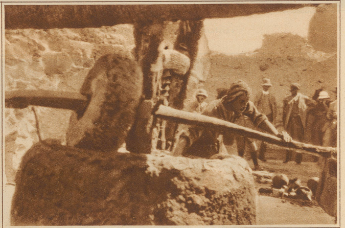
So werden die Oliven gemahlen. Im Hintergrund (Mitte) sieht man einen Teil der zur Presse gehörenden Holzschraube
