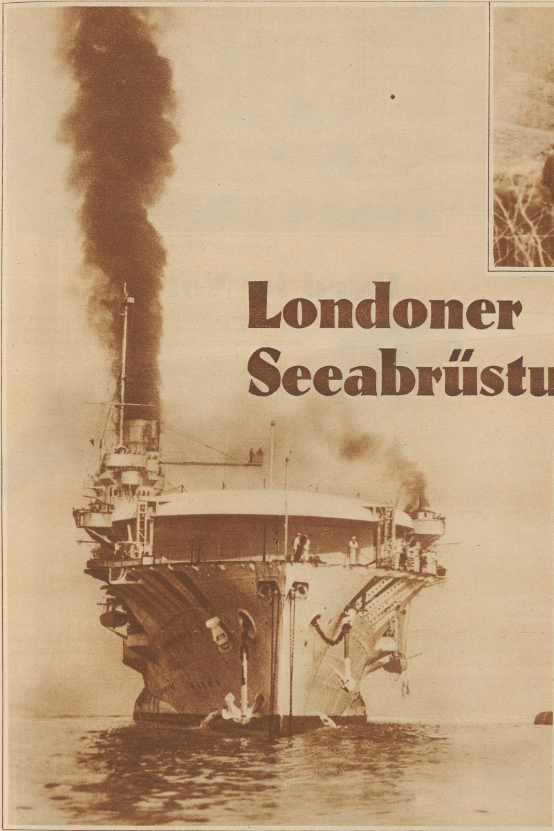
Man spricht von Abrüstung . . . Der im Kriege gebaute englische Kreuzer «Glorious» ist in ein Flugzeugmuttersschiff verwandelt und neuerdings in Dienst genommen worden
