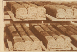
Kein Bäckergerätell mit neuen Schwarzbrotzen, sondern frischer Torf, wie er die Maschine verläßt
