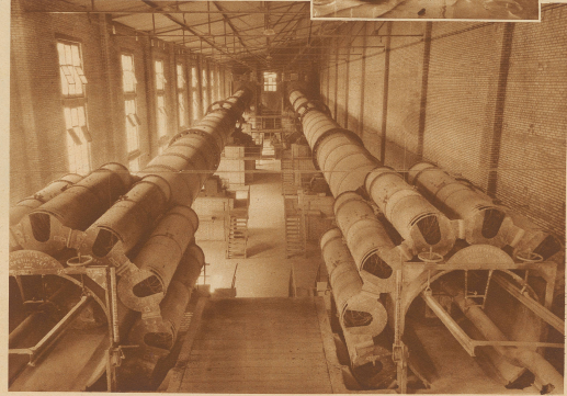
816 rechts: Die 45 Meter langen Röhrenöfen. Oben fließt der Schlamm in die langsam sich drehenden Öfen hinein, wird unterweg bis zur Hälfte gebrannt und kommt unten als harter Klinker heraus. Die am Vorderende sichtbaren, ringförmigen Öffnungen gehören Kühltrömmeln, die zur Abkühlung des glühenden Klinkers
