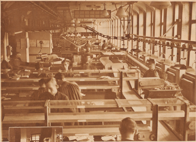
Briefverwand. Von den Stellischen im Vordergrund gelangen die Briefe zu den Stempelmaschinen und dann auf der Schaukelländeranlage in die Grob-sortierung im Hintergrund. Hier werden jährlich etwa 80 Millionen Briefe und viele Millionen Zeitungen verarbeitet.
