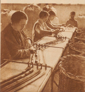
Nebenband foto: Sortieren der Pfropfen auf feinkalibrige Stellen am laufenden Band.
