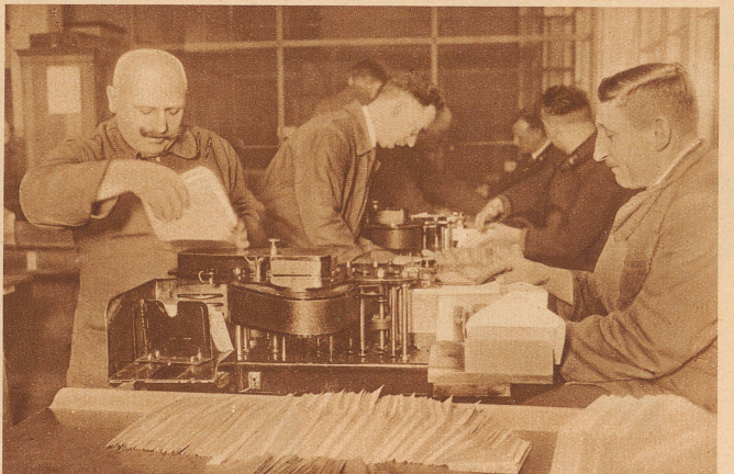
bringt eine moderne Briefschließ- und Stempelmachine täglich 60 000 Briefe fertig zum Versand. Sie wird von zwei ungelerten Arbeitern bedient
