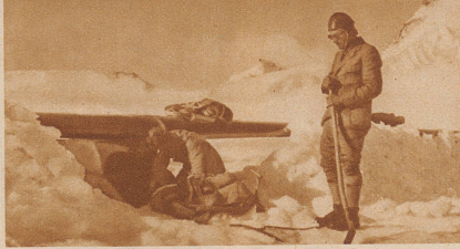
Um die Maschinen vor den heftigen Windstößen zu schützen, mußten sie während der Nacht hinter speziell aufgeworfenen Schneemauern fest verankert und am Morgen wieder ausgegraben werden
