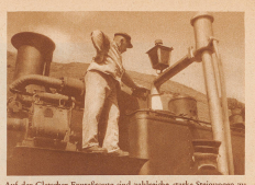
Auf der Gletscher-Expressfahrt sind zahlreiche stark steigende zu überwinden. Kraftanstrengung und Dampfverbrauch der kleinen Lokomotive sind sehr groß. Mehrere Male während der Fahrt muß Wasser gefüllt werden.
