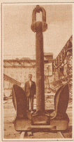
Für der zwei Riesensender des «Rex», die mit dazugehöriger Kette 160 Tonnen wiegen
