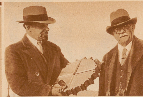
Kapitän Wilkins (links) mit einem der drei Eisfräser, mittelst welchen er einen Schacht durch die Packeisdecke bohren will, um an die Oberfläche zu gelangen
