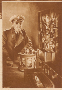
Empfänger (rechts) mit Sensorzeiger (links) eines ferngesteuerten Schiffes
