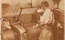
Einer von den vielen, vielen Mischkisten. Jede Gummiqualität hat ihr bestimmtes Mischverhältnis. Jede Änderung in den Mengen der beigefügten Chemikalien verändert die Eigenschaften des Gummi-Endprodukts. Die Mischmeister geben nur Zahlen- oder fingierte Bezeichnungen, niemals die Namen der Mischstoffe. Fährgeheimnis! - Laboratoriumsgeheimnis!
