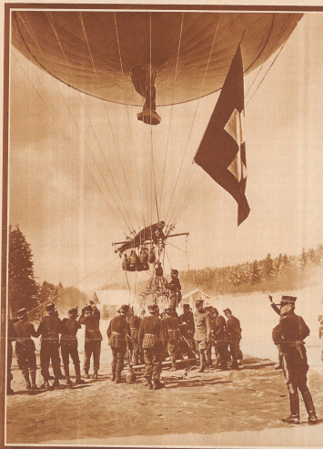
Der Kugelballon, wie er hier klar zum Start bereit ist, hat nur sehr beschränkte Verwendungs-möglichkeit, weil immer bei einer Fahrt mit dem Abtreiben über die Grenze gerechnet werden muß. Meist verwendet man ihn als Fesselballon zur Beobachtung entlang der Grenze, wenn er auch in dieser Hinsicht weit weniger praktisch war als sein arbeitsstarrer Kollege...
