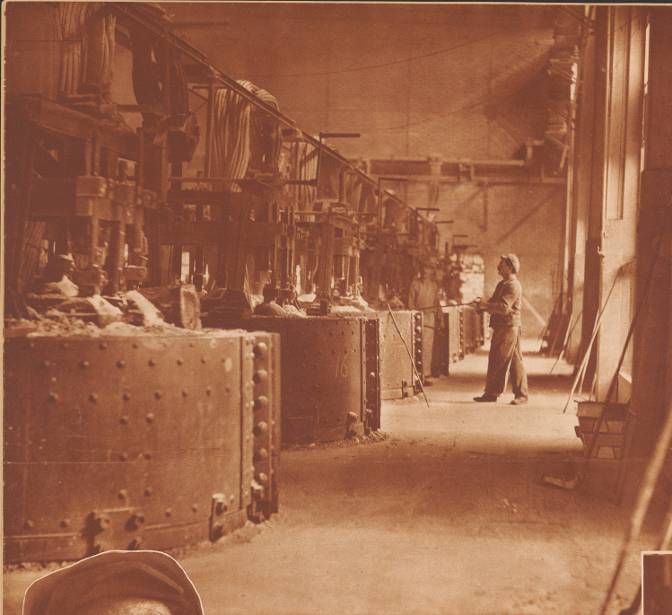
Die aluminiumhaltige Tonerde kommt in Stöcken aus Südafrika nach der Schweiz. Nach den nötigen Vorbehandlungen kommt diese Tonerde in die elektrischen Öfen. Solche Schmelzöfen liegen nebeneinander. Die Tonerde wird zusammen mit Kryolith in diesem Öfen auf elektrischem Wege einer Hitze von zirka 1200 Grad ausgesetzt und geschmolzen. Das Metall Aluminium schiedet aus und sinkt zu Boden.
