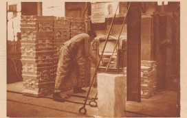
Das aus den Schmelzöfen kommende flüssige Metall wird in kleinen Gefäßen zu Barren gegossen, die man Masse nennt. Die erkalteten Masse können hier nach in einem Gußmaschinen, wie die Bild zeigt, aus diesem Öfen erst wird das Metall in genügender Einheitsgröße gewonnen.
