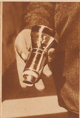
Eine Berliner Firma bringt einen neuen Rescue-Apparat für Ertrinkende den Handel, der großes Aufsehen erregte und vielleicht geeignet ist, das ganze Rettungswesen zu revolutionieren. Es ist ein kleiner flaschenartiger Apparat, der innen mit Carbide gefüllt ist. Im Falle von Gefahr wird er einfach in der Nähe des Ertrinkenden ins Wasser geworfen, versinkt zunächst, taucht dann aber wieder auf, da das Carbide im Wasser Gase entwickelt, die ihn an die Oberfläche treiben. Eine Ballonhülle, die am Kopf des Apparates angebracht ist, wird durch das eindringende Gas aufgebläht und hat eine derartige Auftriebskraft, daß sich drei Personen an dem Apparat festhalten können. — Links: der sogenannte Kiekbusch-Apparat vor dem Hereinwerfen ins Wasser, rechts der aufgeblähte Ballon, an dem sich der Ertrinkende festhält
