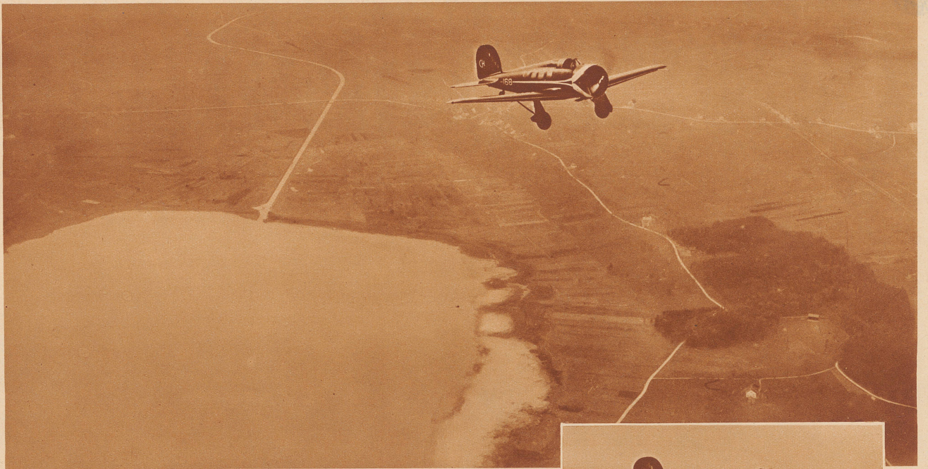
Das neue Schnellflugzeug über dem Greifensee. Das Fahrgestell ist noch sichtbar. Aber wie ein Vogel seine Beine während des Fluges an den Körper legt, kann bei diesen Flugzeugen nach dem Start das Fahrgestell eingezogen werden
