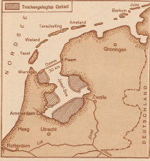
Die Karte zeigt die Hauptlinien des gewaltigen technischen Werkes der Zuiderzee-Trockenlegung. Die schattierten Flächen sind trockengelegte Gebiete. Es bezieht sich vier Provinzen von rund 23.000 Quadratkilometern.
