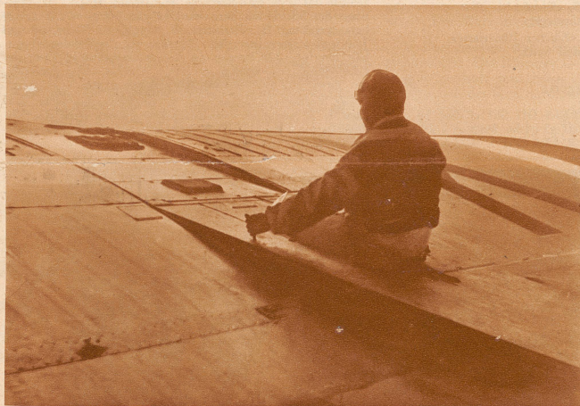
Beim Abflug sitzt der Pilot oben auf dem Dach der Maschine, um freie Sicht zum Startmanöver zu haben. Gashebel, Steuerung, etc. werden durch Verlängerungen bedient, die aus dem Innern der Kabine herausragen . . . .
