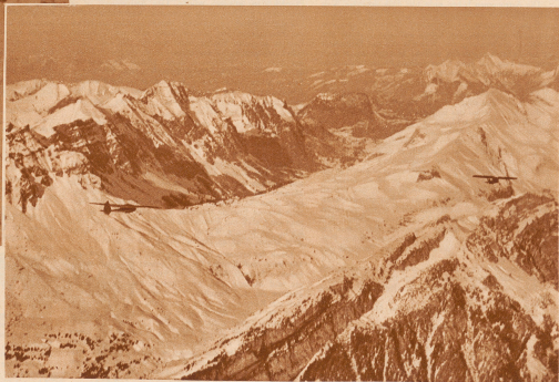
Unterwegs in der Gegend des Klausenpases. Rechts der Schöpferflugzeug, links der Segler. Darunter liegen die 140m Verbindungsseil
