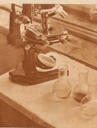
Bei der Titrationmethode tritt in einem bestimmten Moment der Reaktion ein Farbumschlag ein, der den vorhandenen Alkohol berechnet läßt. Das mittlere der drei Köllchen zeigt bereits den Farbumschlag; er ist gelb, während die anderen Köllchen noch kugelförmig sind
