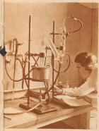
Die Blutprobe wird in einer besonderen Apparatur destilliert. Die Destillation erfolgt bei herabgesetztem Druck und mäßiger Erwärmung. Das Resultat ist vollkommen klar und wird weiter auf Alkohol untersucht
