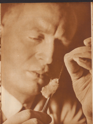
Der Faden, der in das Maß-Instrument eingezogen werden soll, wird sorgfältig und sorgfältig an dem Kettel herangezogen. Es braucht die feine Hand zu dieser Arbeit. Die Dicke des Spinnfadens beträgt nur ein Hundstertel der Dicke des menschlichen Haares. Die meisten Spinnfäden haben einen Durchmesser von 0,003 Millimeter.
