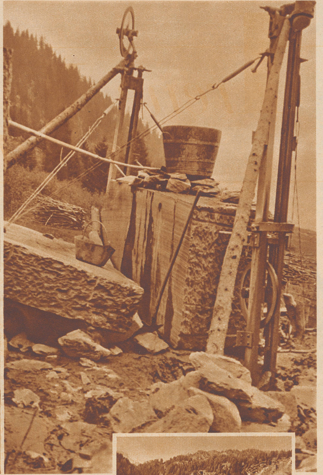
Das Zerschneiden der abgebauten Blöcke erfolgt mit Hilfe eines rotierenden Drahtes.
