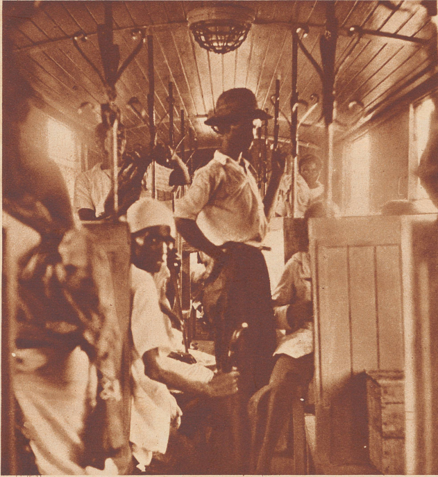
Blick ins Innere eines Eingeborenen-Wagens der Franco-Aethiopischen Eisenbahn. Auf dieser Bahn gibt es zwei Arten von Personenwagen: enge, schlecht gefederte Zweiachser mit großen Fensteröffnungen ohne Glasscheiben für die Eingeborenen, und solche mit einigem Komfort, Polstersitzen und Jalousien, für die Europäer.
