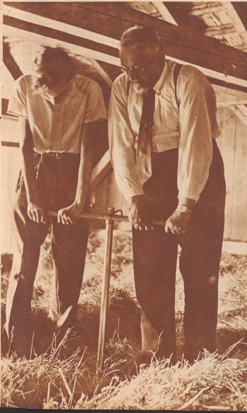
Links: Mittels der Heusonde wird ein verdächtiger Heustock angestochen, um eine allfällige Überhitzung festzustellen. Die Sonde besteht aus einem Eisenrohr mit keramischer Isolierung. Sie ist nach der Höhe des Heustockes verstellbar. Das Anstechen hoher Stöcke erfordert große Kraftanstrengung.
