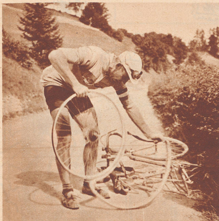
Reifendefekt am Hinterrad! Rad abmontieren, Reifen herunterreißen.
